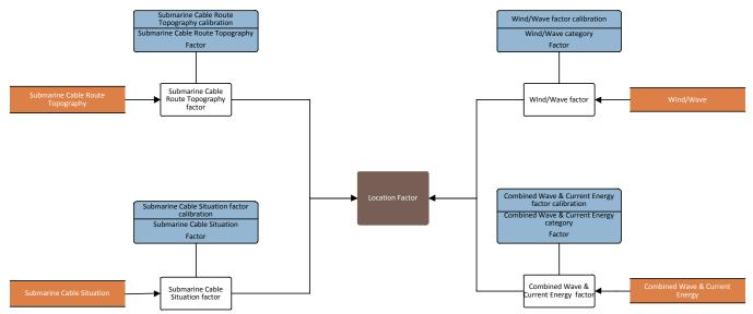
FIGURE 10: LOCATION FACTOR - SUBMARINE CABLES
